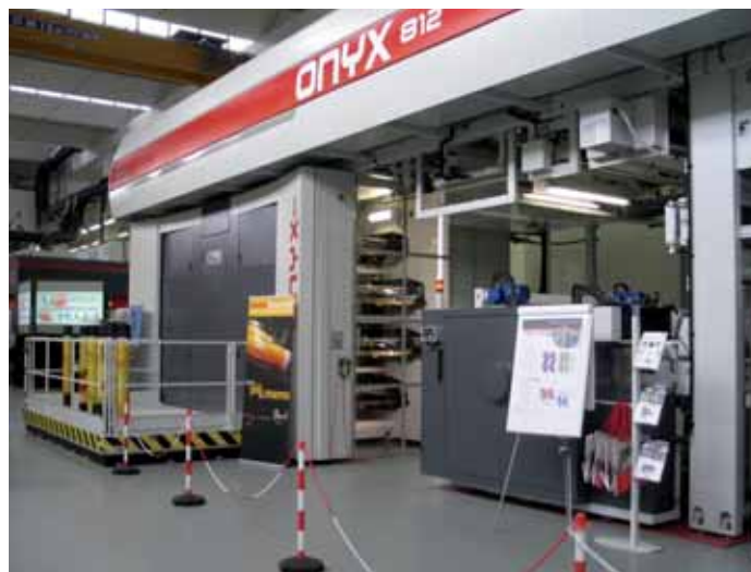
La Onyx 812 di Uteco equipaggiata con due teste inkjet Kodak Prosper, il modello S20, che stampa in nero più un colore
