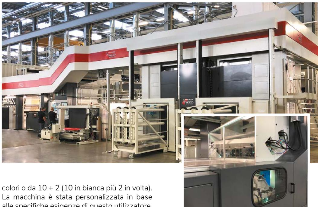
colori o da 10 + 2 (10 in bianca più 2 in volta). La macchina è stata personalizzata in base alle specifiche esigenze di questo utilizzatore, che ha la necessità di stampare su materiali plastici come BOPP, LDPE, HDPE e PETG. Per questa configurazione sono stati dunque sviluppati specifici svolgitori e avvolgitori speciali, e soluzioni all'avanguardia nella gestione del web che permettono la conduzione di vari substrati sulla stessa macchina - non ultimi i film bio based.
