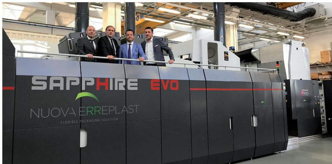
**La macchina messa a punto in Uteco con teste inkjet Kodak è stata presentata come prototipo alla scorsa drupa del 2016, dove ha colpito soprattutto l'altissima velocità (300 m/min e oltre). Ora si annuncia il compimento di un progetto che ha suscitato interesse e attese e di cui sarete i primi**
